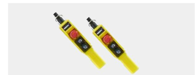
手电门开关--通过标准快接插头连接在葫芦上，低压控制开关并带急停按钮设计。手电门电缆线均为高品质铜芯，手电门及电线重量集中在钢丝绳上，大大提高电缆寿命。
