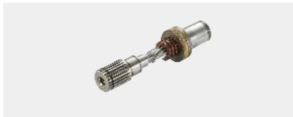
超离合器--集成在传动齿轮轴上，起到超载保护功能。保持扭矩高达安全载荷的1.4倍免维护设计，超载力矩可调。
